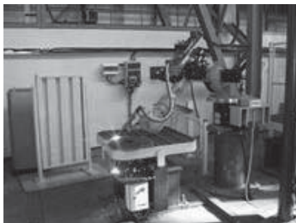
Zdjęcie 8: Zrobotyzowane ukosowanie blach
