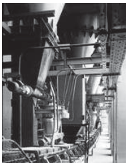
Zdjęcie 4: Linia automatycznego odważania i dozowania surowców szklarskich w Hucie Szkła Okiennego „KARA” S.A. w Piotrkowie Trybunalskim
